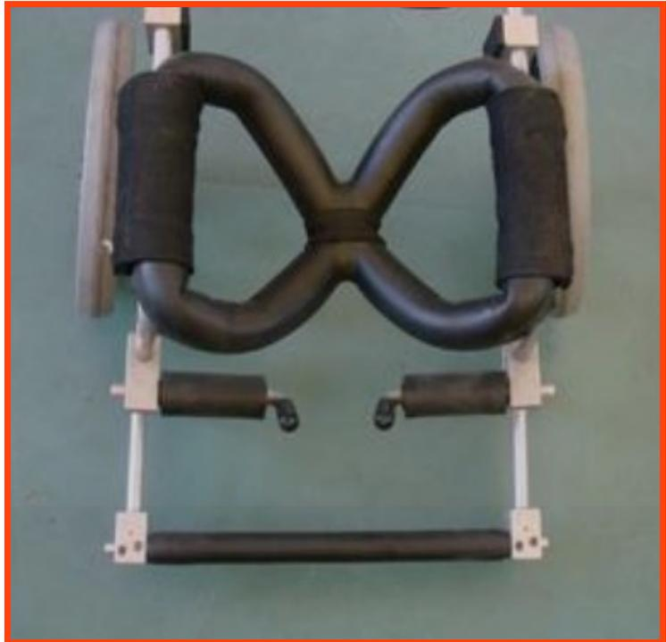
*Der Eddie's Wheels-Sattel ist aus Aluminium geschweißt und mit feuchtigkeitsabweisendem Chirurgie-Schaum gepolstert. Er gibt dem Hund zwischen den Hinterläufen stabilen Halt. Der K9-Sattel beispielsweise besteht aus einem einfach ummantelten und lose verbundenem Kordelsystem. Auf dem Foto sieht man sogar die Spuren von Pflegepulver um bereits hervorgerufene Irritationen zu lindern.*
